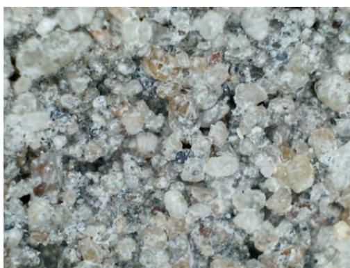
**Figura 5.** Corpo-de-prova sem adição de pó cerâmico.
