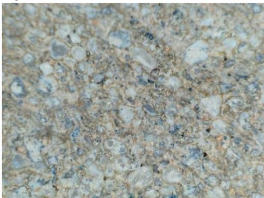
**Figura 4.** Microscopia óptica no corpo-de-prova com 20% de pó cerâmico (aumento de 100 vezes)
