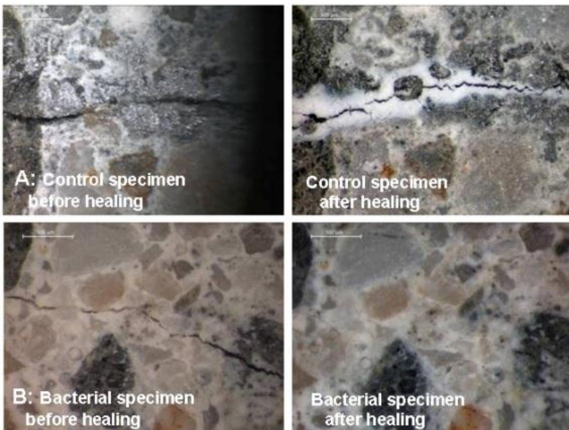
**Figura 1.** Fig.1A: Fotografia do espécime de controle antes da cura e após a cura, respectivamente. Fig. 1B: espécimes bacterianos antes e depois da cura, respectivamente. Imagens obtidas com o microscópio de luz e ampliadas em 40 vezes. Fonte: JONKERS, 2011.
