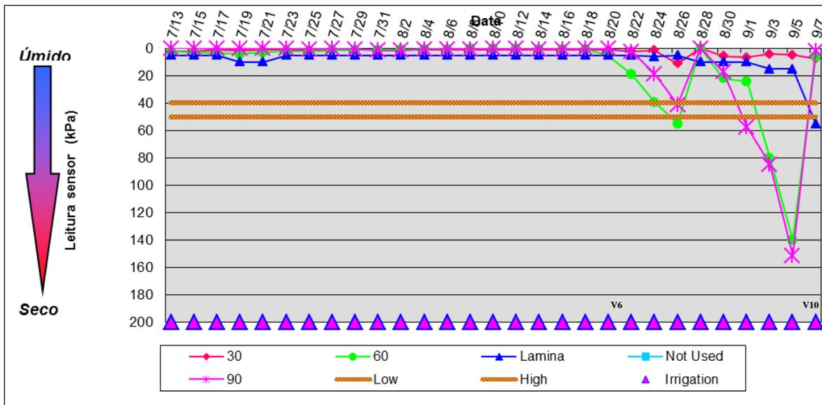
**Figura 1.** Flutuação da tensão de água no solo medida com sensores Watermark a 30, 60, 90 cm de profundidade. Média de 10 repetições. Lâmina: múltiplos de 0,5 L.dia<sup>-1</sup> x 10.
