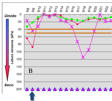
**Figura 2.** Flutuação da tensão de água no solo medida com sensores Watermark a 30, 60, 90 cm de profundidade. Média de cinco repetições sob irrigação diária (A) e secamento progressivo de 07/09 a 09/09 (B). Seta azul mostra o dia de retomada da irrigação.
